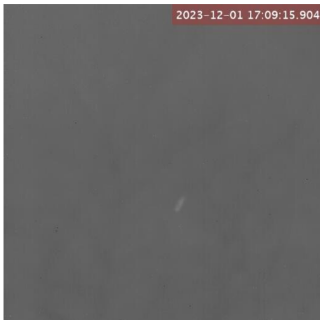
图 22 晴朗天气下线性倍增模式对飞机的成像图 2
