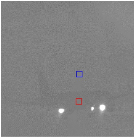
图19 阴雨条件下常规成像模式飞机成像图
