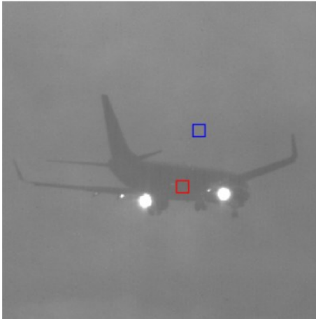
图20 阴雨条件下线性雪崩模式飞机成像图
