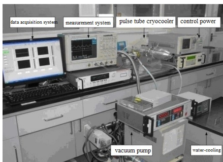
Fig. 2 Pulse tube cryocooler test system 图2 脉管制冷机测试系统
